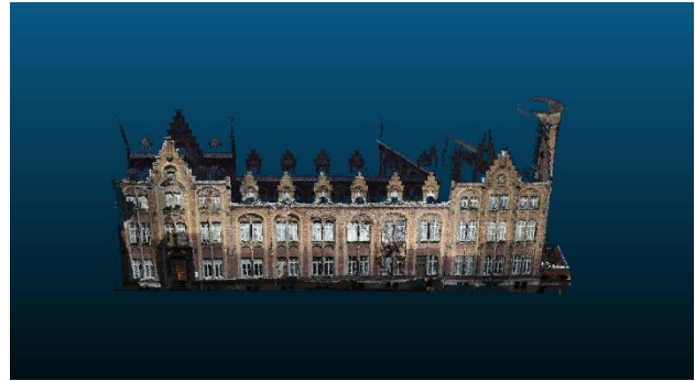
Figuur 14: foto + scandata gecombineerd in Cloud Compare
